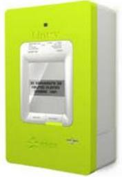
Le compteur d'électricité Linky utilise le courant porteur en ligne (CPL), signal à plus haute fréquence se superposant au courant électrique alternatif 50 Hz permettant l'échange de données et d'ordres avec un concentrateur. Les compteurs de type **G1** utilisent les fréquences **63,3 kHz et 74 kHz** pour communiquer alors que ceux de type **G3** utilisent la bande de fréquences comprises entre **35,9 kHz et 90,6 kHz**
